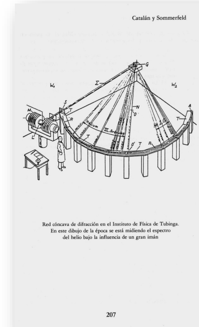
Montaje experimental (Instituto de Física de Tubinga) ilustrando la medida de espectros bajo campo magnético y usando una red de difracción cóncava.
